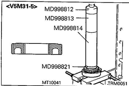
**▶B◀ KUPPLUNGSNABE FÜR HECK-/ALLRADANTRIEB EINBAUEN**
