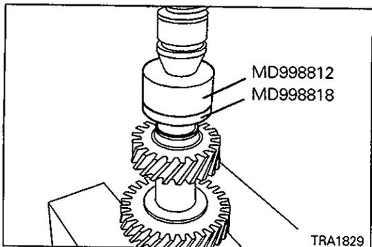
**HINWEISE ZUR MONTAGE****▶A◀ INNEREN LAUFRING, ROLLENLAGER UND DISTANZSCHEIBE EINBAUEN**
