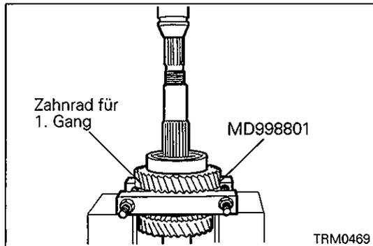
◊B◊ **Kugellager und Lagerhülse ausbauen**
